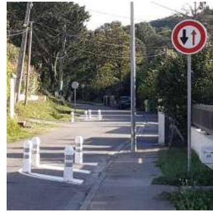
Des travaux de voirie sur le chemin de Mariette ont permis d'inclure un dispositif permettant de limiter la vitesse des véhicules. Il s'agit d'écluses qui réduisent ponctuellement et alternativement la largeur de la chaussée à une voie, la vitesse est également limitée à 30km/h.
